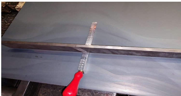
Obr. 23 Princíp merania rovinnosti
