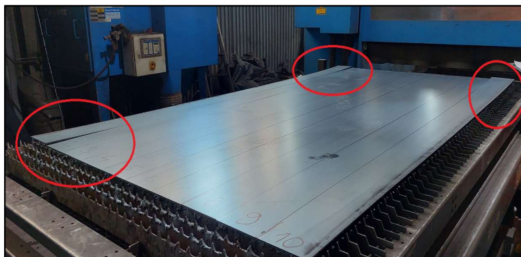
Obr. 24 Princíp merania vnútorných pnutí
