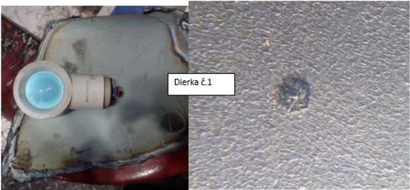
Vzorka defektu z tepleho plechu
